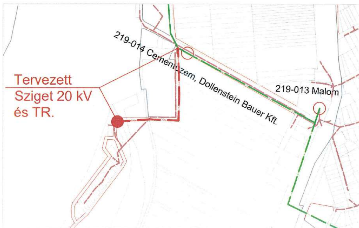
T-9 Villamosenergia-ellátási javaslat (2018) – a telkek kiefeszültségű hálózata kiépített, a strand villamosenergia-ellátására tervezett 20 kV-os vezeték és transzformátor a módosításba bevont utcákat nem érinti:
